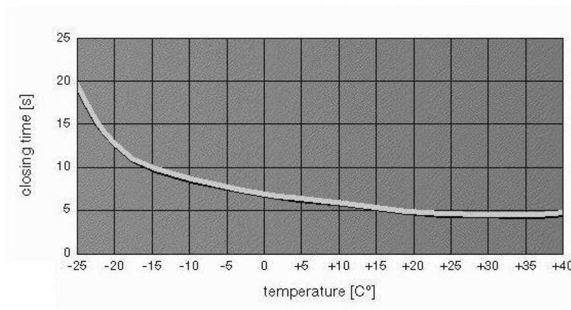
Z grafu je patrné, že je-li dveřní zavírač umístěn uvnitř budovy (například na domovních dveřích) a běžná teplota nevybočí z rozmezí  $-5^{\circ}$  až  $+20^{\circ}$ , neměl by být rozdíl v rychlosti zavření dveří větší než cca 3s. Podmínkou je samozřejmě instalace dostatečně kvalitního a silného zavírače a jeho správné nastavení (velmi častou chybou je nahrazování síly zavírače rychlostí zavírání – zavírač se potom nedá z dlouhodobého hlediska správně nastavit).
